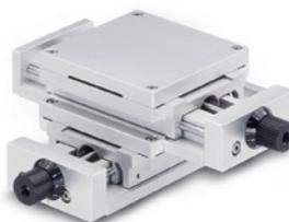
Регулируемое устройство позиционирования и фиксации с перемещением по осям X-Y-Z, состоящее из 3 регулируемых кареток GN 900 (см. стр. 668), комплекта соединительных элементов для осей X- и Z с индикатором положения, в сочетании с поворотным столом GN 900.6 (см. стр. 677), установленным на ось Z и смонтированным на монтажной пластине GN 900.4 (см. стр. 675).
