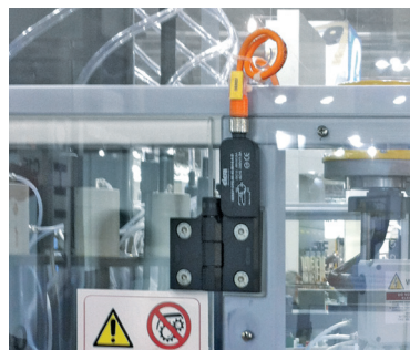
Применение петли CFSQ со встроенным предохранительным выключателем.
