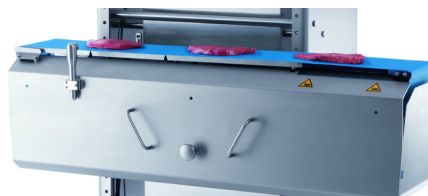
Применение лепестковых ручек из нержавеющей стали GN 5335
