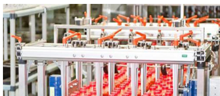
Применение регулируемых ручек из нержавеющей стали GN 300.5
